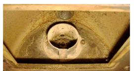
1. controllare che sia stata pulita, eventualmente usare l'aspiracenere (aprire per verificare che non sia anche lui da svuotare). notate che il fornello è un tubo con un largo anello al centro.
